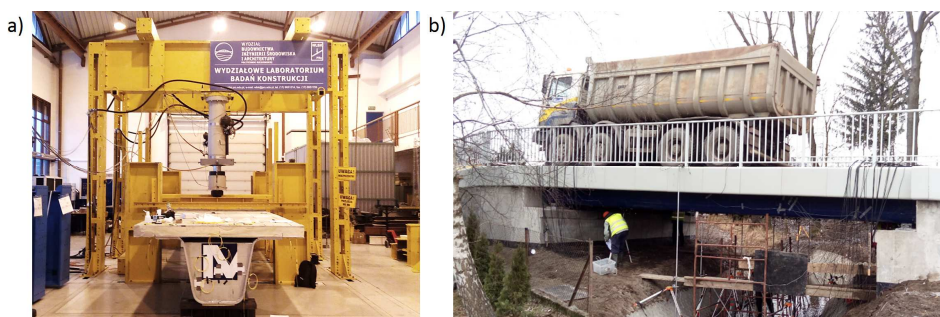
Rysunek 6. a) Widok stanowiska badawczego w Laboratorium Politechniki Rzeszowskiej; b) widok badanego mostu kompozytowego w czasie obciążenia próbnego
