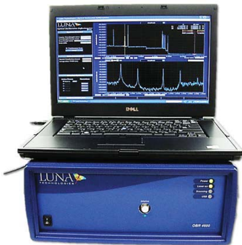
Rys. 2. Reflektometr optyczny LUNA OBR 4600 wraz z laptopem z zainstalowanym oprogramowaniem do przetwarzania sygnału pomiarowego
